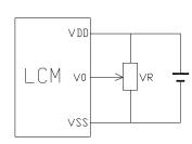
$V_{\text{DD}\sim}V_0$ : LCD Driving voltage
